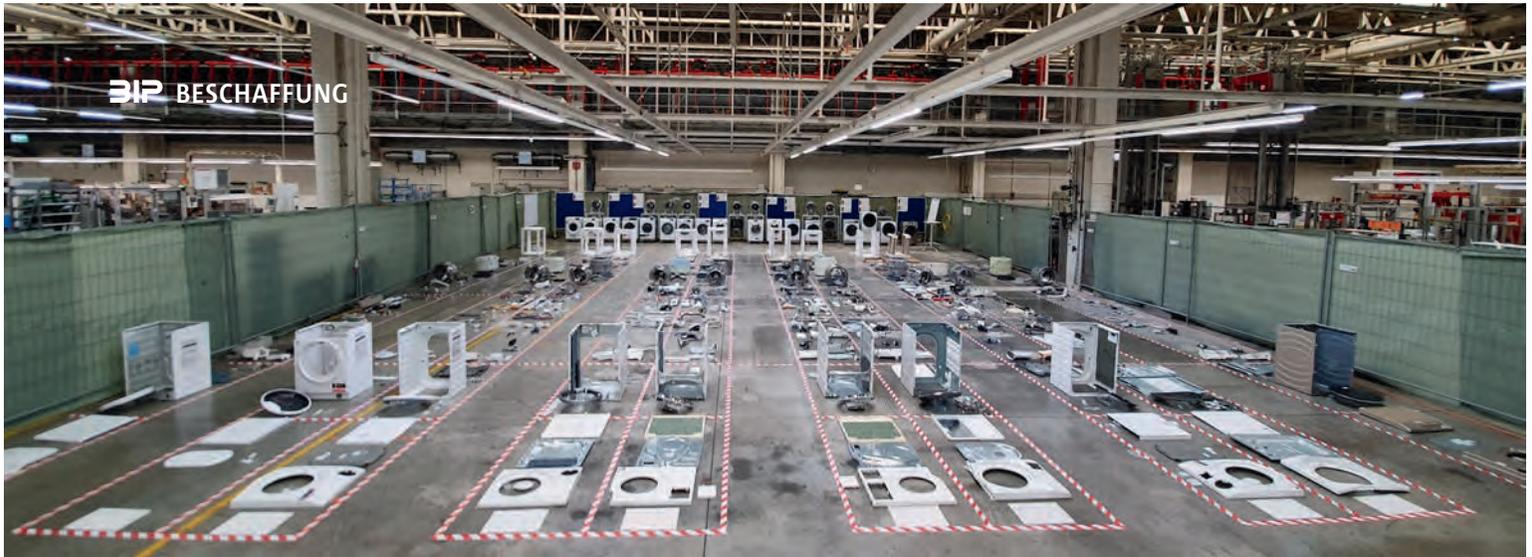
Im Rahmen des Design-to-Value-Prozesses bei Miele wird zunächst eine Workshop-Fläche errichtet. Dazu werden sowohl eigene Produkte als auch Wettbewerbsprodukte in ihre Bauteile zerlegt.
