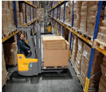
**Für Engstellen.** Dank Lithium-Ionen-Batterie ist der aktuelle Hochhubwagen von Jungheinrich der kürzeste seiner Klasse – der Batterietrog für den (größeren) Blei-Akku fiel weg. Hierfür gab's 2020 den iF-Design-Award. Mit 60 Zentimeter schmal und damit ideal für den Transport in engen Gängen ist zudem ein neuer Elektroschlepper des Herstellers. Trotzdem zieht er drei Tonnen. Er hat einen Lithium-Ionen-Akku für den Mehrschichtbetrieb.
