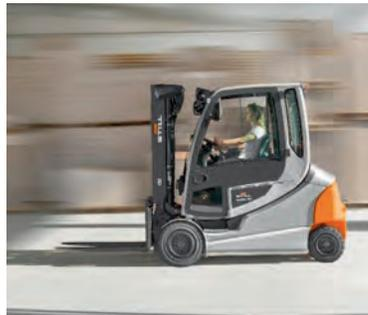
**Wendig und schnell.** Still hat im März seine Baureihe RX 60-25/35 neu aufgelegt. Die Stapler haben dank neuem Antriebskonzept die höchste Umschlagsleistung in der Gewichtsklasse bis 3,5 Tonnen und erzielen Fahrleistungen auf Dieselniveau. Ihre Höchstgeschwindigkeit: 21 Stundenkilometer bei satter Beschleunigung. „Es gibt keinen Grund mehr, keinen E-Stapler zu fahren“, erklärte zur Produkteinführung Thomas Fischer, CSO von Still.
