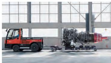
**Power aus Brennstoffzellen.** Innerhalb von Minuten betankt, unabhängig von Stromlastspitzen, leistungsfähig und vor Ort emissionsfrei: Der Brennstoffzellenantrieb ist eine alternative Energielösung, wenn Unternehmen große Flotten betreiben und den Geräten sehr hohe Leistungen abverlangen, mit vielen Betriebsstundenzahlen im Mehrschichtbetrieb. Neu auf dem Markt ist dieser Linde-Schlepper mit Brennstoffzelle und 25 Tonnen Zugkraft für den Einsatz etwa auf Flughäfen.
